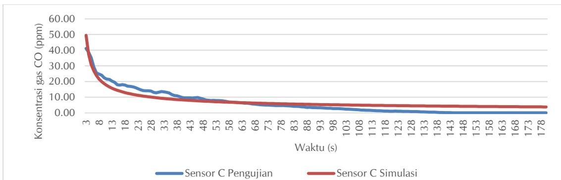
Gambar 5. Grafik perbandingan penurunan konsentrasi gas CO pada pengujian dengan hasil simulasi sensor C terhadap waktu
