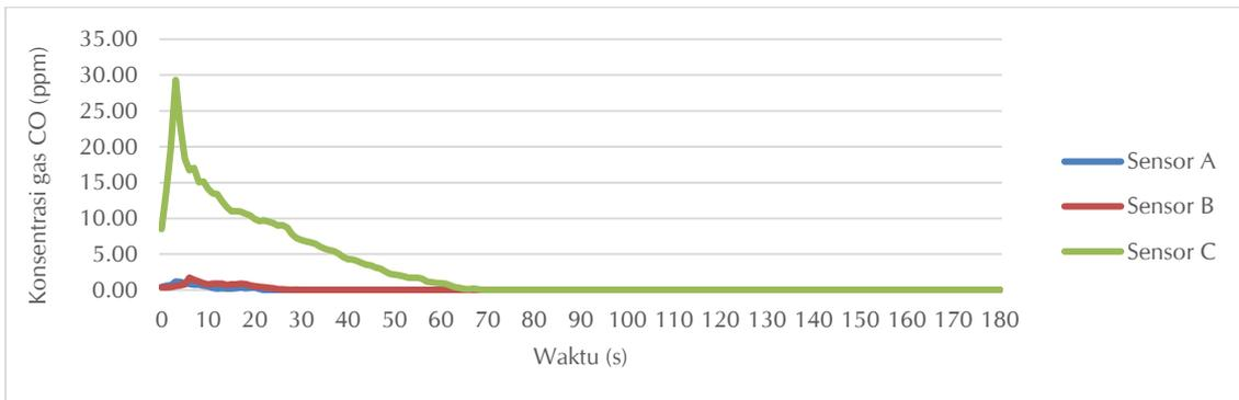
Gambar 4. Grafik penurunan konsentrasi gas CO terhadap waktu pada kondisi 1
