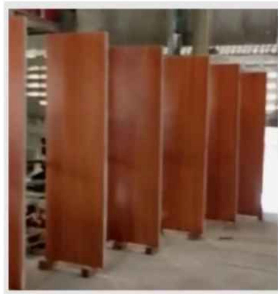
Gambar 12. Hasil finishing fuliture daun pintu beton ringan motif polos
